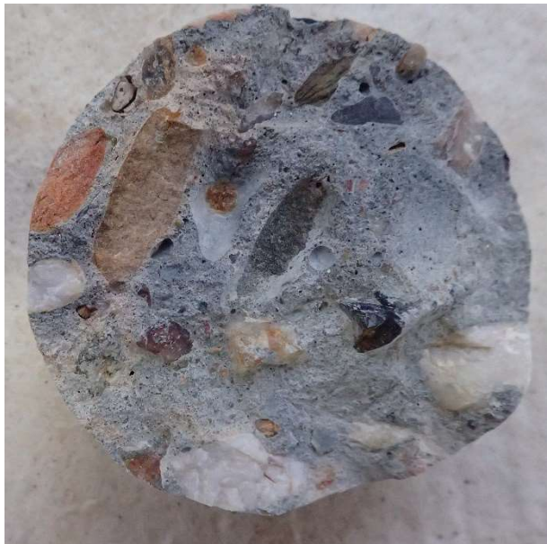
Obrázek č. 19: Fotodokumentace vývrtu V10 – vlevo pohled na zkoušenou lomovou plochu, vpravo pohled na kolorimetrickou zkoušku
