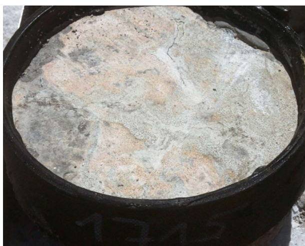
Obrázek č. 18: Vzorek CH4 po 75 zkušebních cyklech – vlevo zkušební povrch, vpravo rozpad dolní části zkušebního tělesa
