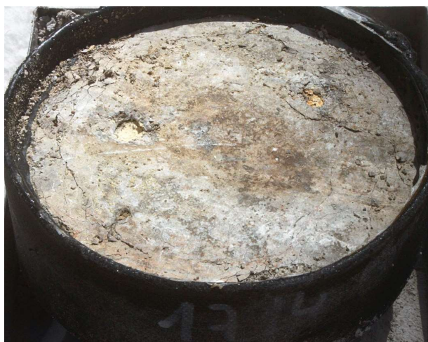
Obrázek č. 17: Vzorek CH3 po 75 zkušebních cyklech – vlevo zkušební povrch, vpravo rozpad dolní části zkušebního tělesa
